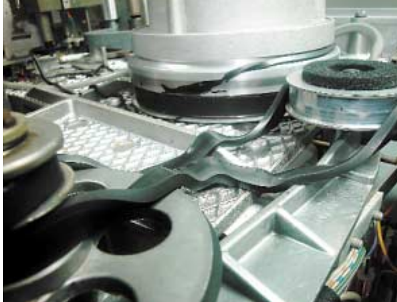
«Verflüssigter» Antriebsriemen in einem Videogerät der späten Sechzigerjahre (Philips 1" EL 3402).
