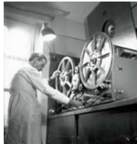
Eine Stahlbandmaschine der Firma Lorenz, wie sie ab 1937 auf Wunsch der SRG in den Radiostudios verwendet wurde. Der Ausbau des Kurzwellendienstes, die dezentrale Produktion der Sendungen für die Landessender und die zunehmende Belegung der Musikleitungen machte den Gebrauch einer einzigen, zentral betriebenen Maschine zu kompliziert.
